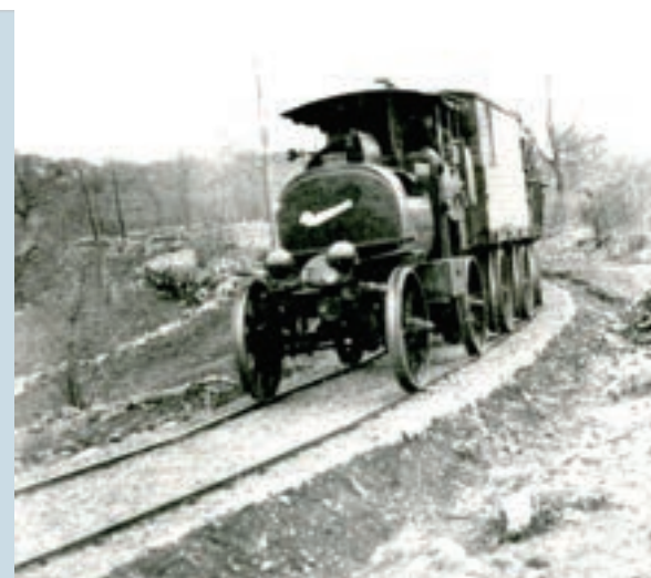
Poljska vojaška ozkotirna železnica z lokomotivo na dizelski pogon. (fototeka: Goriški muzej)
