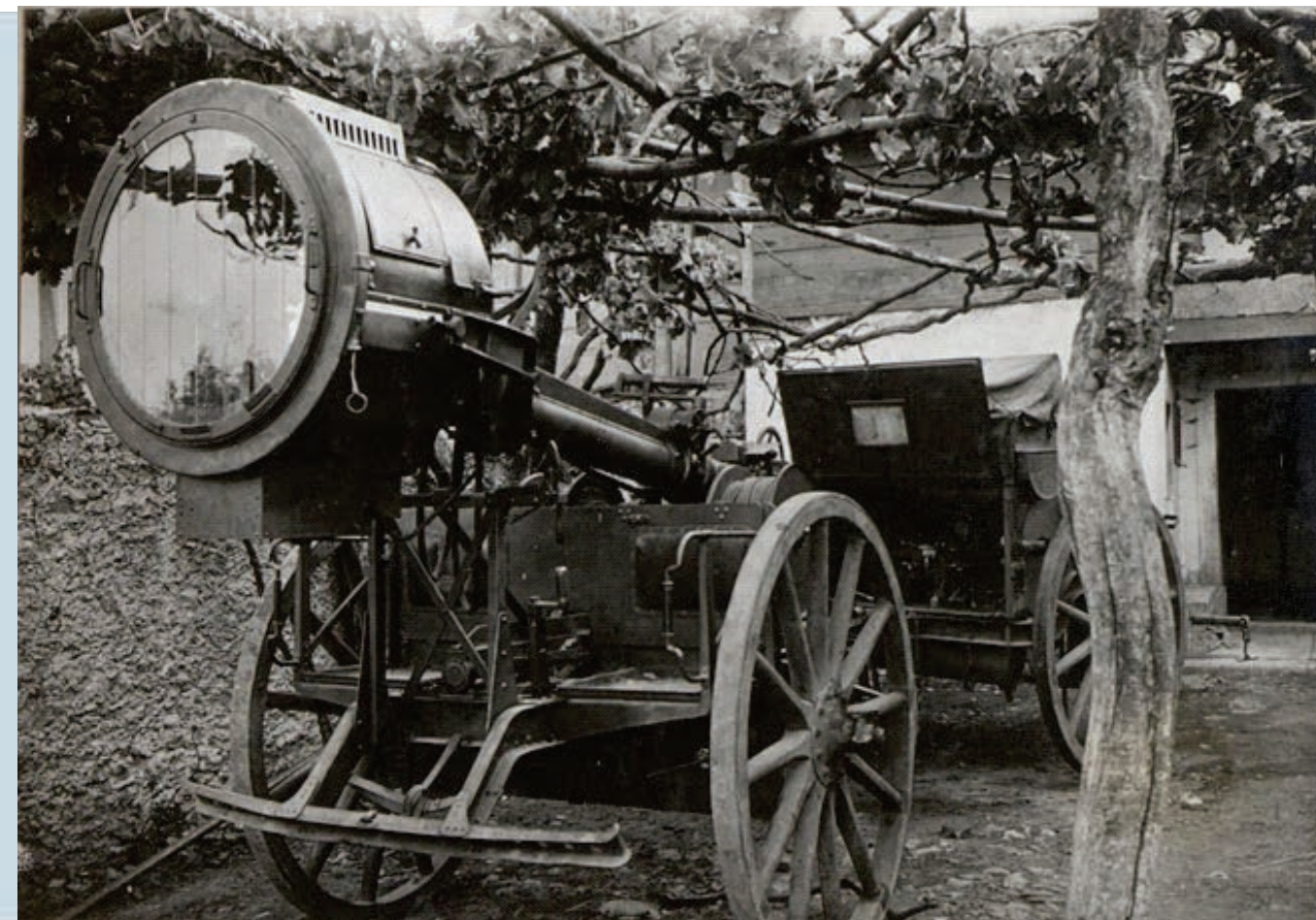
Reflektor za nočno opazovanje neba na vozu. Zadnji del je bil sam reflektor s potrebnim sistemom za dviganje. Prednji del pa je poleg sedeža – kozla za voznika in posadko imel še »omaro« za opremo, baterije in agregat. (foto: Europeana)
