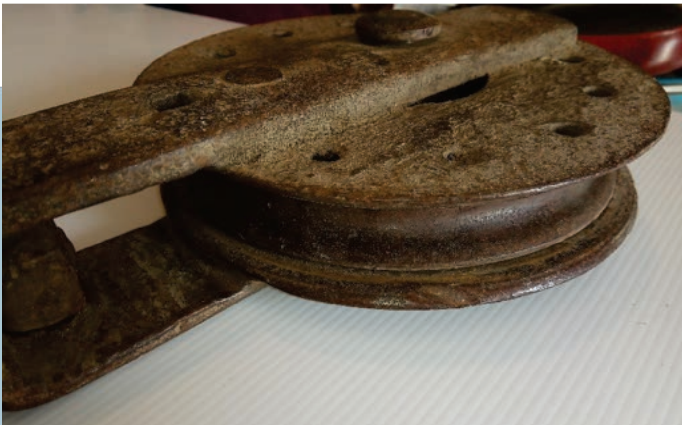
Gozdarski škripec za vleko hlodovine iz Trnovskega gozda, narejen iz žičniškega kolesca in polovice prečnega nosilca, ki je povezoval dve kolesci. Za škripec so uporabili samo eno kolesce. Škripec je last družine Nemeč iz Lokavca. (foto: Boris Blažko)
