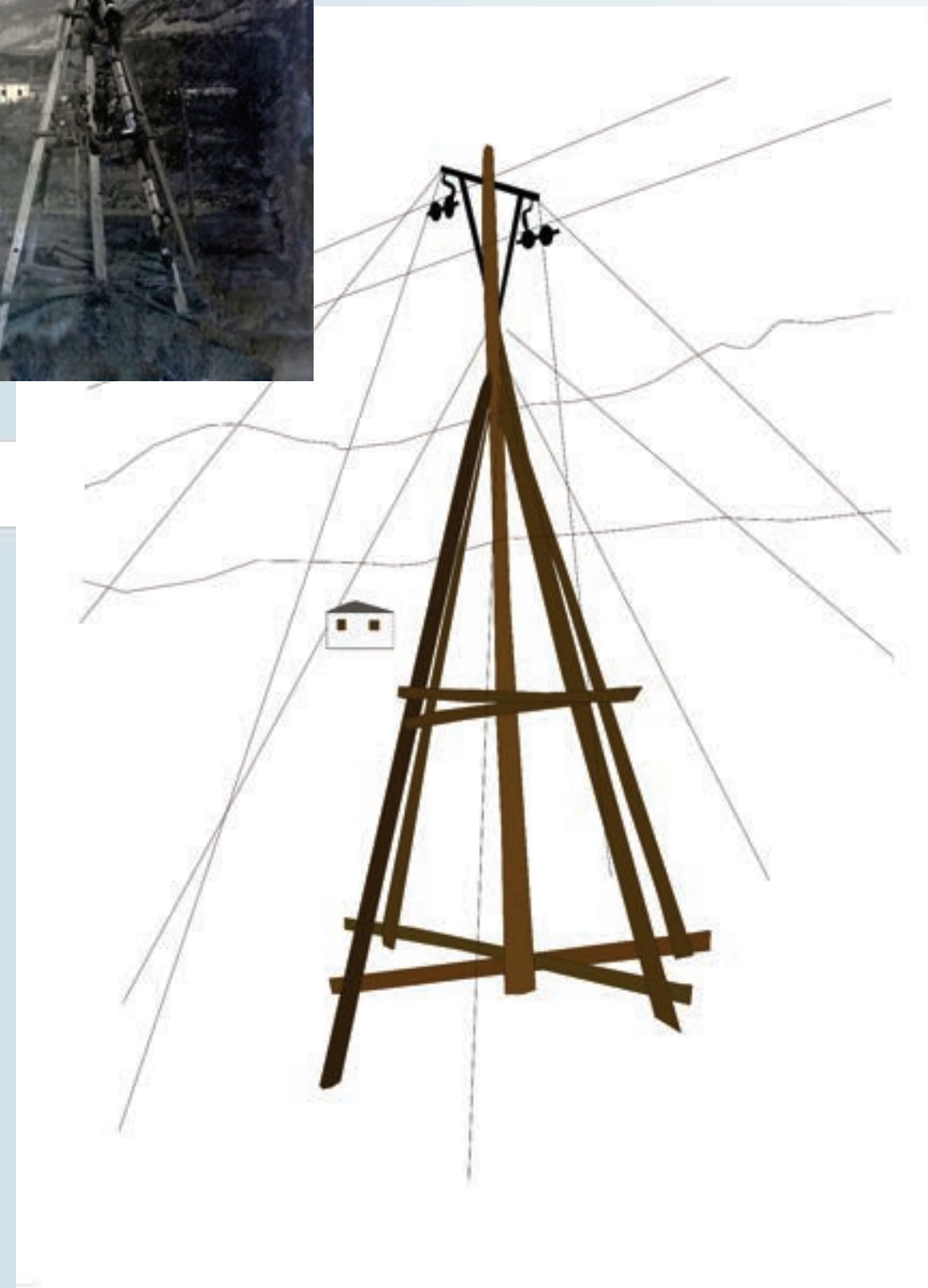
Fotografija in skica rekonstrukcije stebra ter njegova učvrstitev z tramovi in več jeklenicami. (foto: Čopič, skica Boris Blažko)
