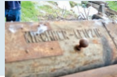
Poravnalna „ubelmašina“ izdelana v tovarni Kirchner & Co v Leibzigu za potrebe avstro-ogrške vojske. Živa priča vojaškega zaledja in razvoja ajdovske industrije – mizarstva. (fototeka; Goriški muzej, foto; Boris Blažko)
