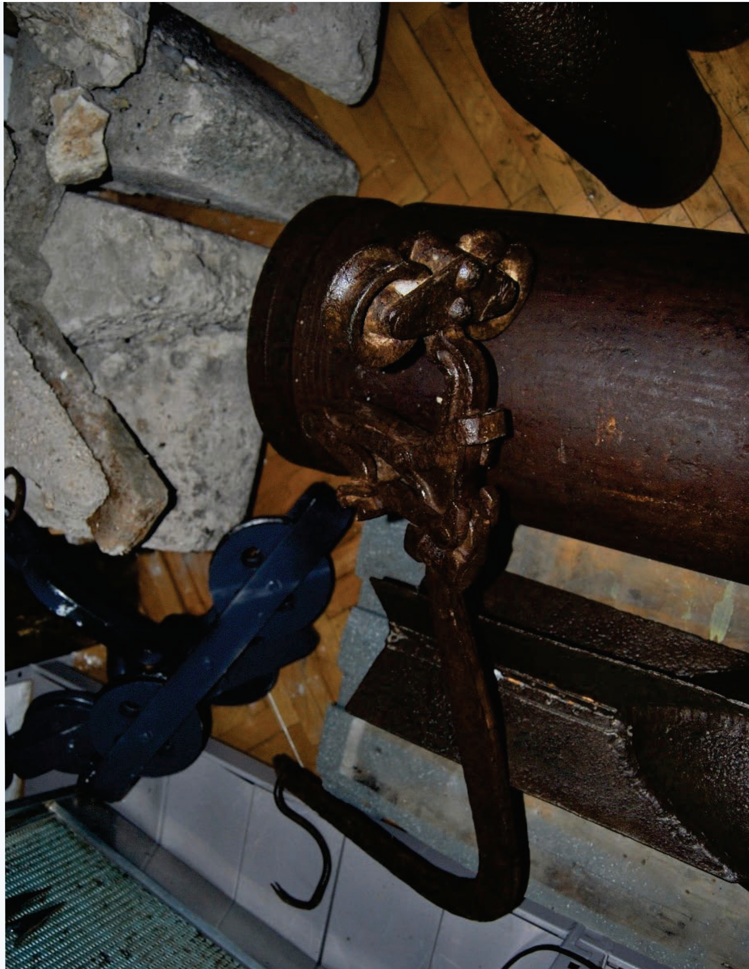
Voziček proizvajalca Bleichert & Co. iz Leipziga s kljuko za obešanje vreč. (foto: Boris Blažko)
