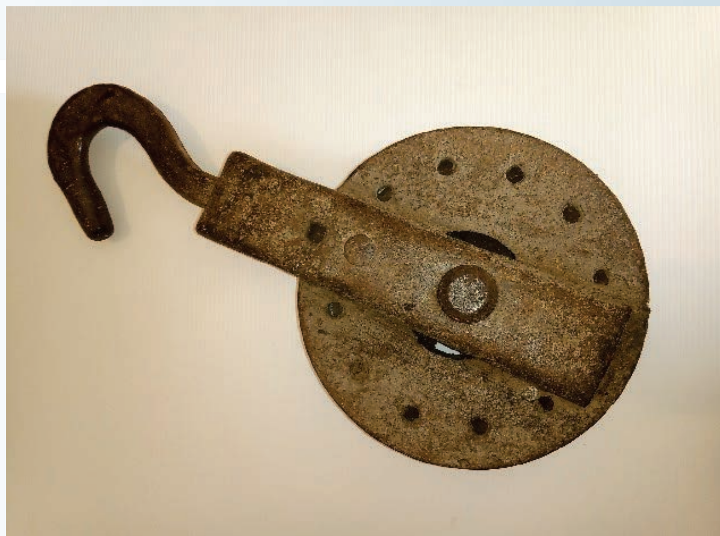
Gozdarski škripec za vleko hlodovine iz Trnovskega gozda, narejen iz žičniškega kolesca in polovice prečnega nosilca, ki je povezoval dve kolesci. Za škripec so uporabili samo eno kolesce. Škripec je last družine Nemec iz Lokavca. (foto: Boris Blažko)
